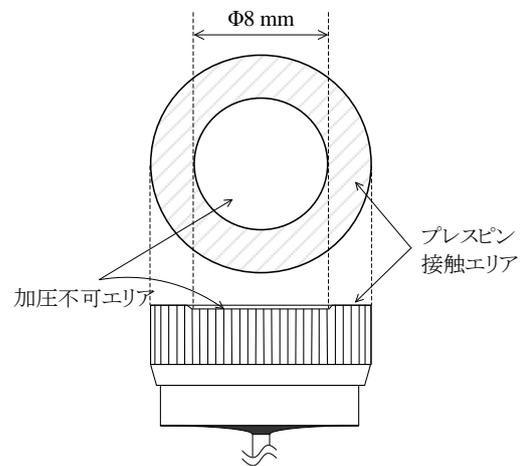
図 8 プレスピン接触エリア
