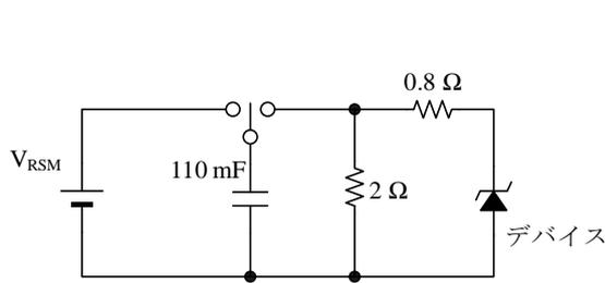
図 1 ピーク非繰返し逆電圧測定回路
