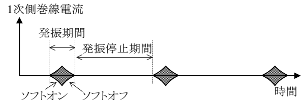
図 9-20 スタンバイ動作波形
